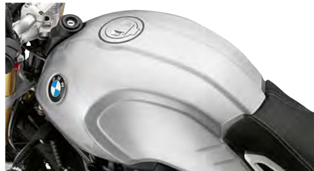
АЛЮМІНІЄВИЙ ПАЛИВНИЙ БАК З РУЧНИМ ШЛІФУВАННЯМ ТА НЕВИДИМИМ ЗВАРНИМ ШВОМ
